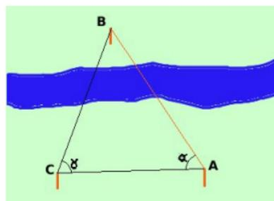
Possiamo spostarci in un punto C e calcolare la distanza AC ed inoltre gli angoli  $\hat{A}CB$  e  $\hat{C}AB$ . Abbiamo quindi il triangolo ABC di cui conosciamo due angoli ed il lato compreso; possiamo calcolare il terzo angolo ricordando che la somma degli angoli interni di un triangolo è un angolo piatto,  $\beta = 180^\circ - \alpha - \gamma$ . Per il teorema dei seni
